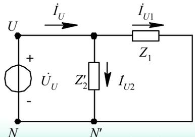
图 5.13 两组对称负载的三相电路
