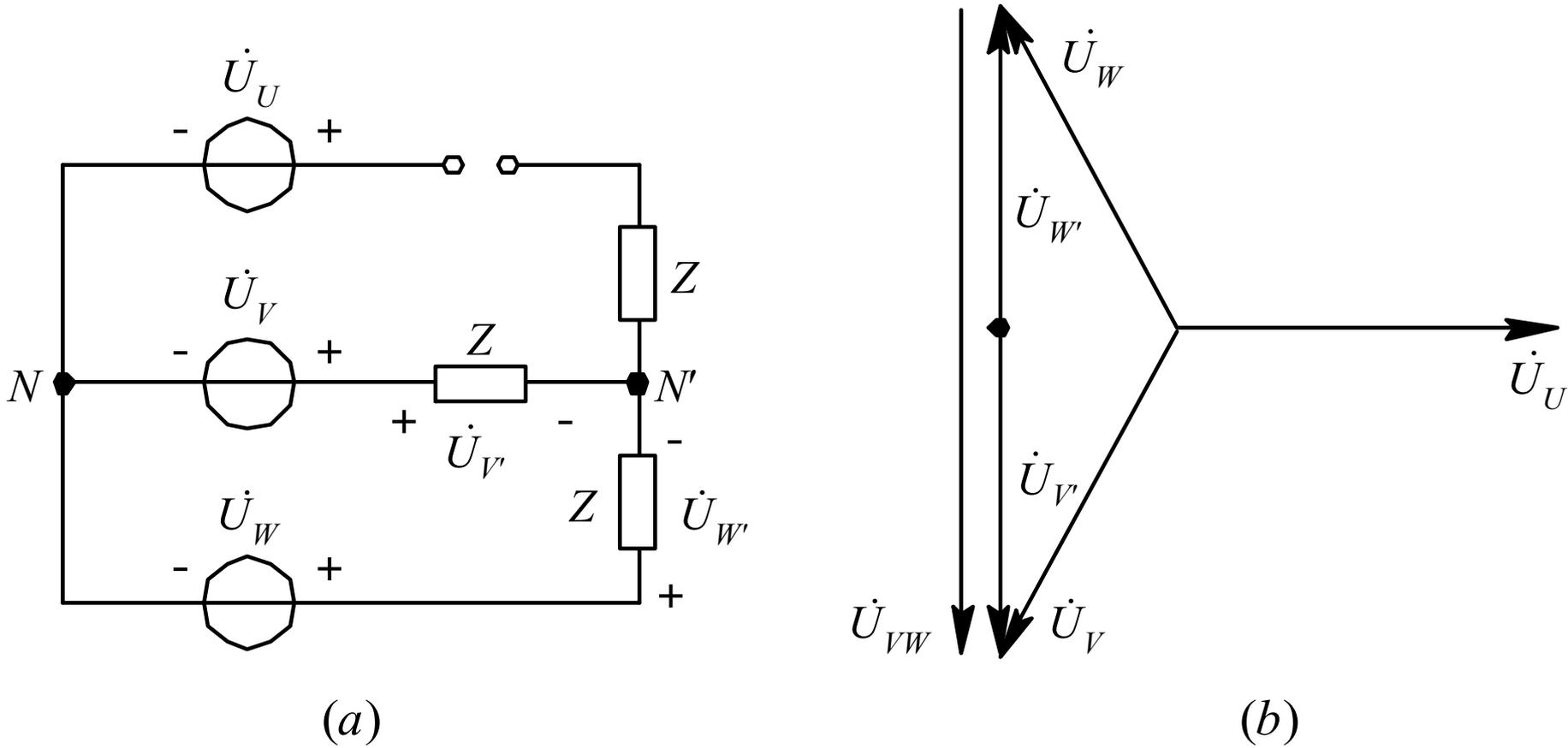
图 5.21 对称星形连接U相断路及其相量图
