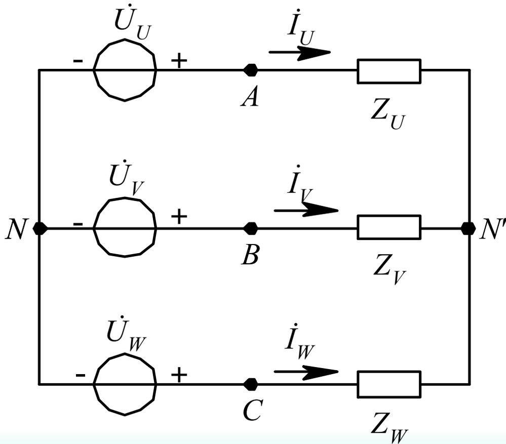
图 5.9 负载为Y形连接的三相三线制电路
