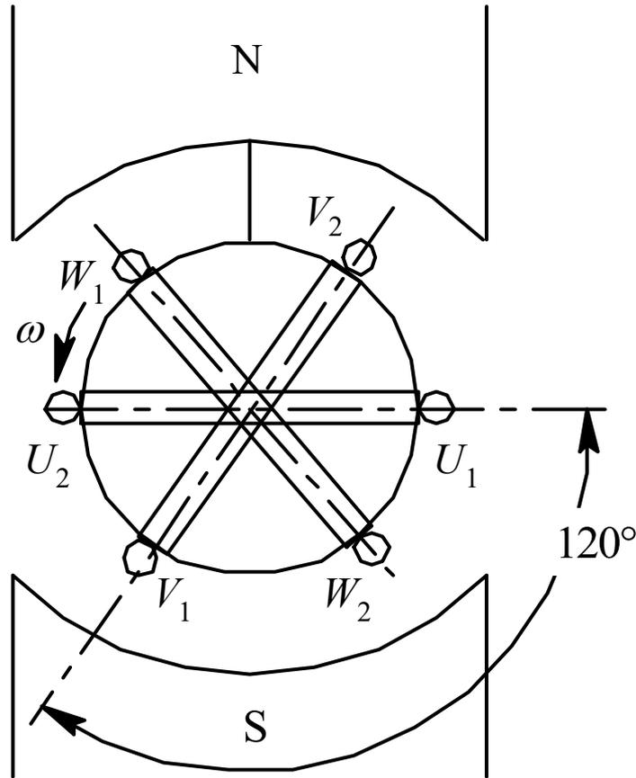
图 5.1 三相交流发电机的原理
