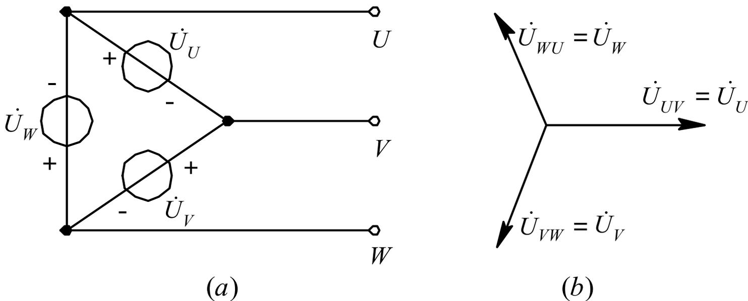
图 5.6 三相电源的三角形连接线电压等于相电压
