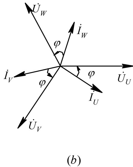
图 5.8 三相四线制电路及电压、电流相量图
