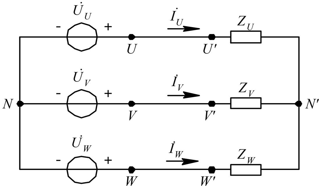
图 5.17 三相三线制电路
