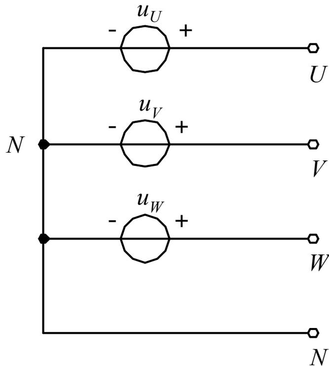
图 5.4 三相电源的星形连接
